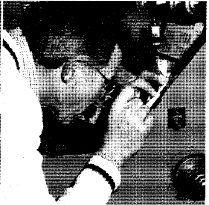
afb. 6 - de drukker controleert of er wel goed in in register wordt gedrukt.
